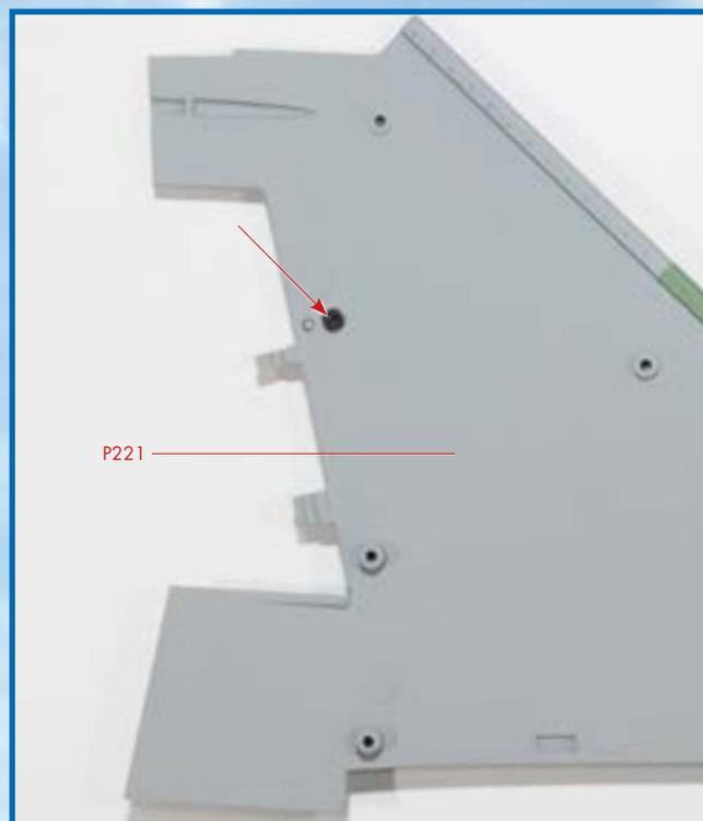
**5** Вставьте обтекатель привода управления (P222) в отверстие на лицевой стороне детали P221, как показано на снимке.
